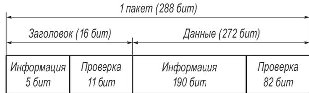
Рис. 1.37. Структура сопутствующей информации в скремблированном сигнале
